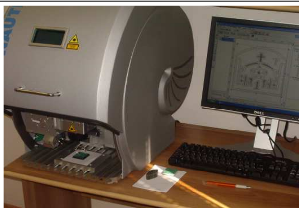
laserové označovacie zariadenie NAUTILUS
