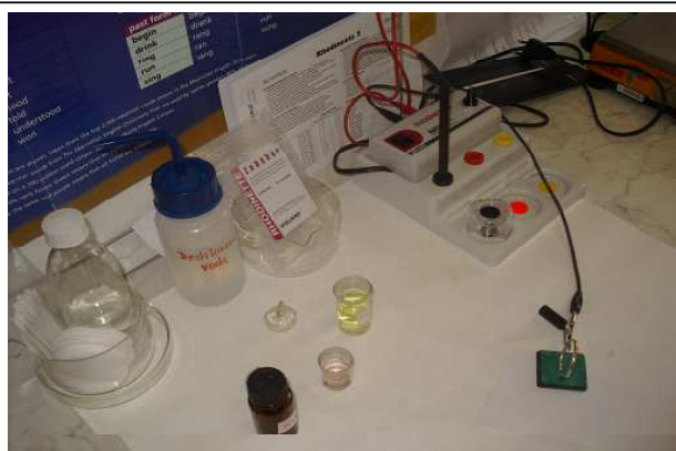
Galvanická pokovovacia súprava slúži pre odstránenie stôp po laserovom označovaní šperkov
