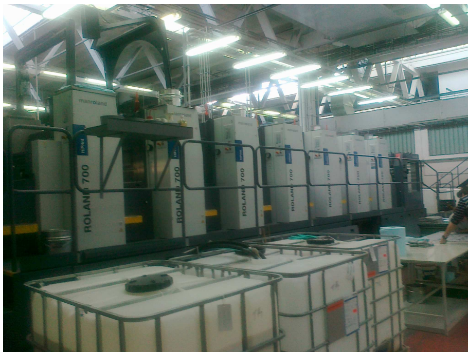
2/ 6-farebný ofsetový stroj s lakovacou jednotkou Manroland R-706 LV v prevádzke
