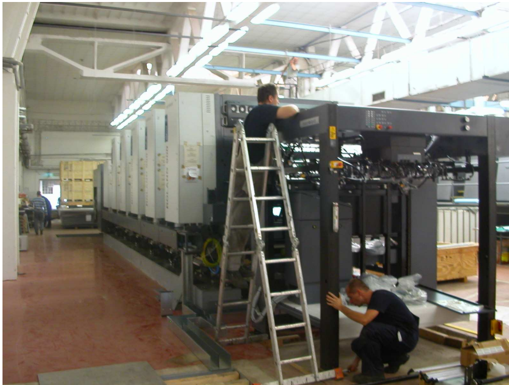
3/ Montáž veľkoformátového tlačového stroja (maximálny hárok 1400 x 1000 mm) manroland R-905 LV
